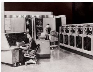
Mesa de controle do computador de grande porte, UNIVAC-1105, adquirido pelo IBGE para apuração do Recenseamento Geral de 1960.
