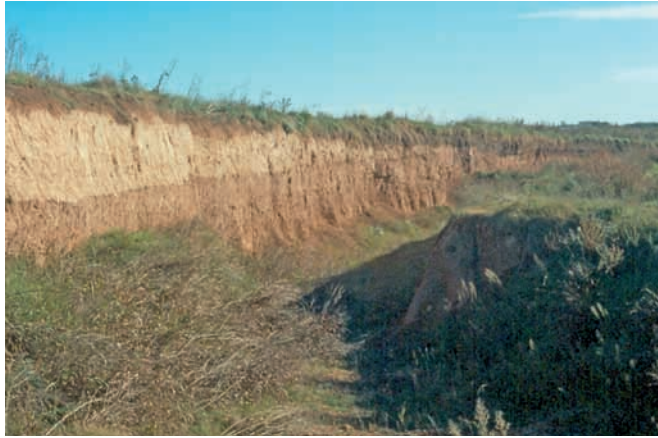
Excavación para extracción de "tosca" en el área rural cercana a Buenos Aires. Puede observarse el contraste entre los sedimentos superficiales Pospampeanos, donde se ha desarrollado el suelo actual, y los sedimentos subyacentes del Pampeano (Formación Buenos Aires), arcillosos y con abundante carbonato de calcio ("tosca").
