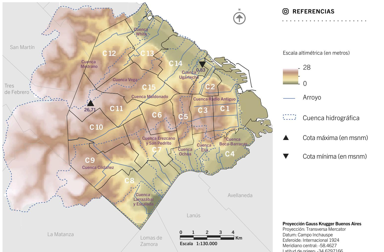
**Nota:** para la representación de las alturas se generó un modelo raster a partir de la interpolación de curvas de nivel en un modelo TIN. El Instituto Geográfico Nacional (IGN) emplea como horizonte hipsométrico de referencia el nivel medio de las aguas del mareógrafo de Mar del Plata.
